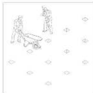
3. Pour concrete in the holes
